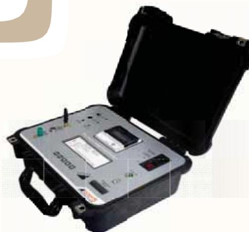
Medições em tempo real e sem fios das correntes de fuga resistivas do 3º harmônico de para-raios de AT/EAT, com compensação de harmônicos do sistema.
