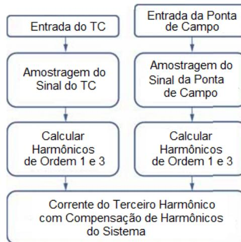
**Método 2:** Método da Tensão de Pico conforme a IEC 60099-5-A1 (Opcional)
