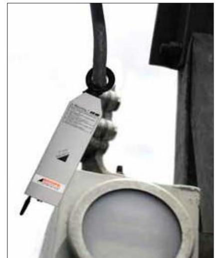
**Método 1:** Medição da Corrente de Fuga Resistiva com Compensação do Terceiro Harmônico (IEC 60099-5-B2)
