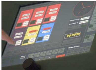
Devido ao grande número de configurações possíveis de canal de saída, o equipamento também possui um chaveamento interno, de modo que as alterações nas saídas não precisam ser feitas pelo operador nos terminais de saída nem no controle, pois isto é executado automaticamente no AIC na sua opção de configuração. Esta facilidade evita erros e poupa tempo durante os testes.
