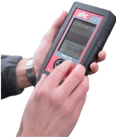
A unidade de controle portátil Raptor-HH é uma interface amigável a partir da qual o usuário pode comandar o sistema remotamente e monitorar o processo de teste. A unidade pesa apenas 0,4kg, incorporando um display TFT com conexão sem fio, escrita via caneta apontadora e botão de controle de funções, proporcionando uma facilidade de uso sem precedentes nesta classe de equipamento de teste.
